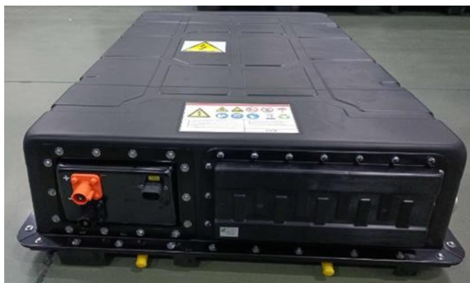
Rysunek 6 Moduł baterii chłodzony cieczą
