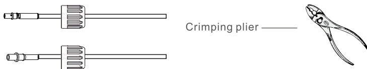
Rys. 3.4 Zaczepianie pin stykowy na przewodzie
